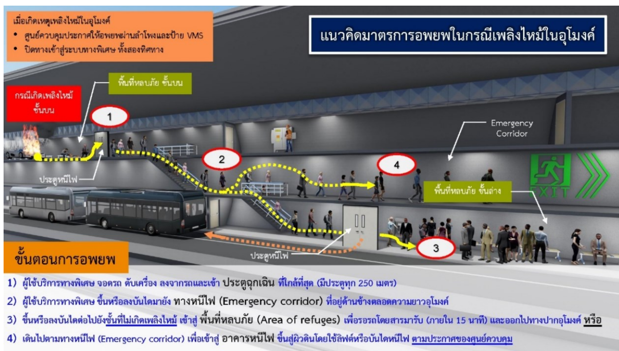
รูปที่ 6.9-2 แนวคิดทางออกหนีไฟในอุโมงค์
